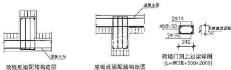
顶板反梁配筋构造图
